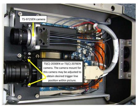
Figure 34. VIS-CAM400IIT-2030 and VIS-CAM400IIT-2076 overview
